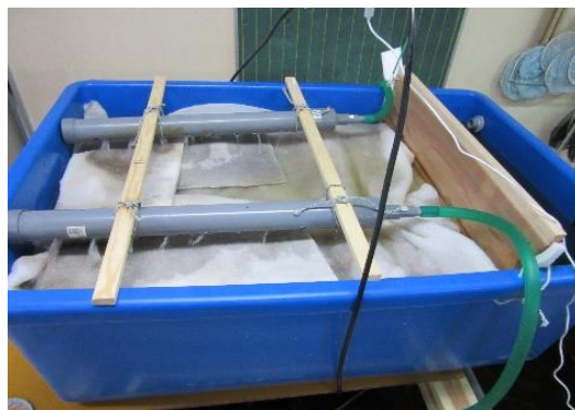
実証水槽のろ過槽
